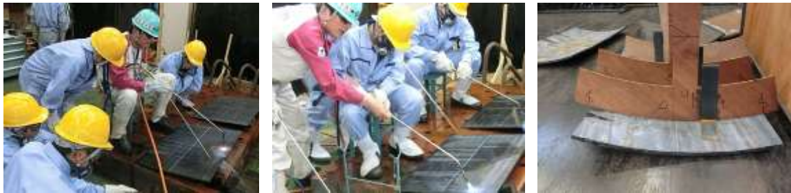
図9 熟練技能者による匠の技・ぎょう鉄の実技指導・ぎょう鉄で曲げた作品
