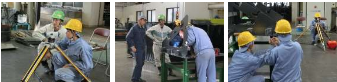
図10 測量器使用の練習・ブロックの部材の仮止め・模型ブロックのねじれ修正
