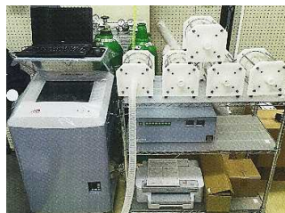
【生体ガス分析用質量分析システム（マルチ5連仕様）】 運動中のヒトの呼気の分析
