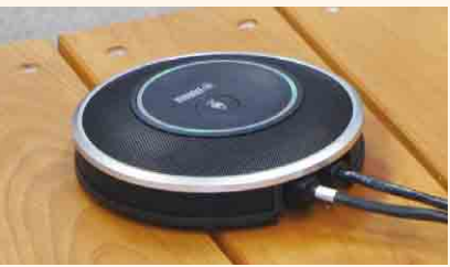
▲收音中のマイク 電源を切らずにミュートを用いている様子（上部にボタンがあり、ミュートのオンオフが切り替えられる）
