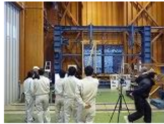
図9 静的破壊試験の様子
