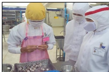
(図3 冷凍たこ焼きに入れるタコを1つずつ手で触って、貝殻やウニの棘などの異物がないかを検品する)
