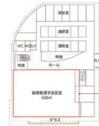
5階平面図：大スパンを生かした大部屋利用 大部屋、小部屋のレイアウトに自在に対応可能な平面計画
