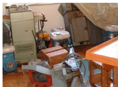
技術室の工作機械の転倒
