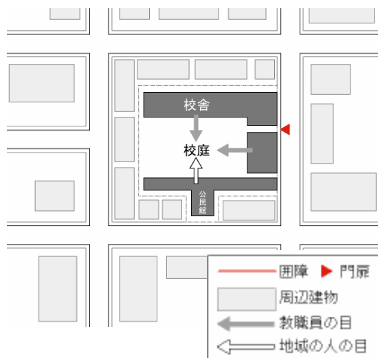
写真 3-3-3 敷地の外周を建物の外壁で囲い、門扉を設置した例
