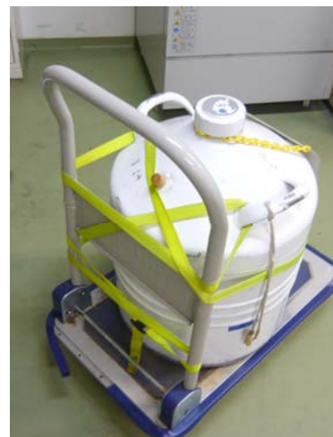
運搬中に液化ガスの容器が倒れないよう 台車に固定されている。
