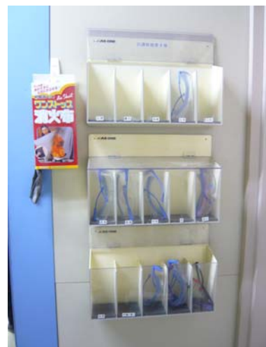
実験室内の入口横に保護めがね置場を設け、すぐに着用できるようにしている。
