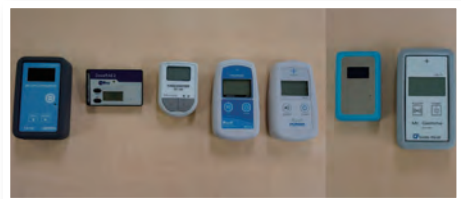
身の回りの放射線(β線、γ線)を調べる測定器
