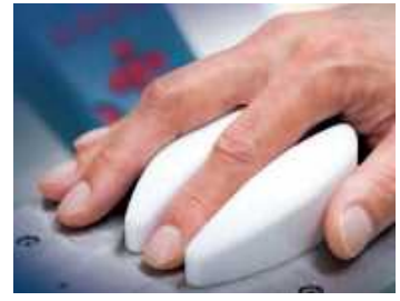
（プロトタイプ機） 採血なしに指先で光に触れるだけで血糖値が測定できる
