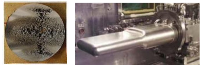
SNSの標的容器で観測されたピitting損傷の実例
