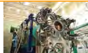
物質の電子状態を観測するミュオンスピン回転分光器
