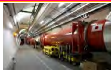
陽子ビームの衝突頻度を上げるために重要な役割を果たすLHCビーム衝突点超伝導磁石
