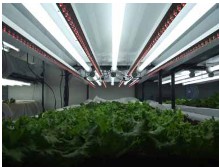
図11 蛍光灯 + LED + 有機栽培の結合実験
