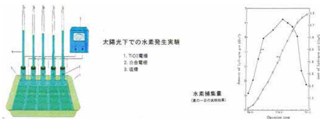
図7 太陽光下での水素発生実験
