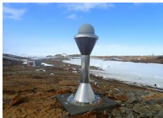
GNSS連続観測点
