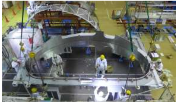
20度セクターVVTSのインボードとアウトボードの仮合せ
