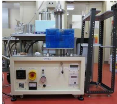
機械物性測定用に整備した弾性挙動測定装置(左)、及び機械特性測定装置(右)
