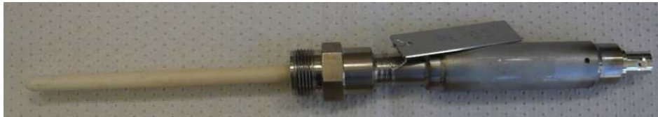
JAEAで開発した酸素濃度センサ
