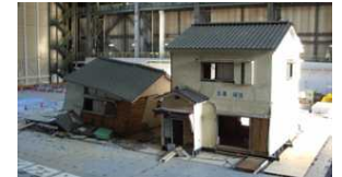
E-ディフェンスによる震動実験
