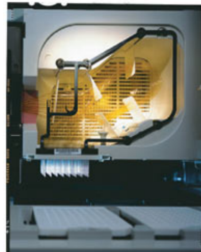
ABI社3730xlシーケンサーのキャピラリーアレイ(写真提供: Applied Biosystems社)
