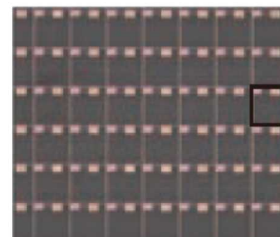
塗布法で作製した数多くのCNT素子が並ぶTFTアレイ
