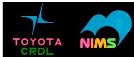
図: アルミニウムを用いた表面プラズモンカラーフィルタの光透過像。
