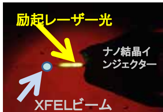
可視光レーザーによるマイクロ秒ポンプ&プローブ実験
