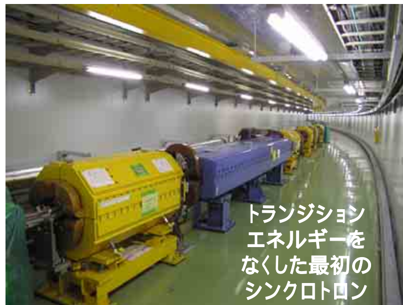
トランジション エネルギーをなくした最初のシンクロトロン トランジションエネルギーをなくすため、 双極磁石が抜かれている。
