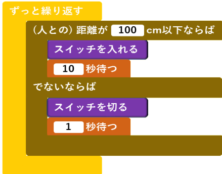
図〇 通電を制御するプログラムの例
