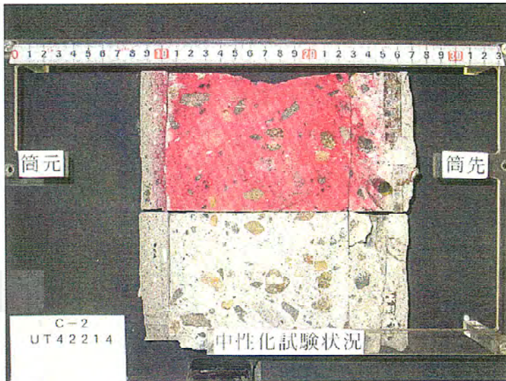
写真-3 中性化状況 (C-2)
