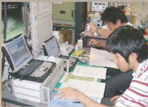
オゾンゾンデ観測風景 オゾンゾンデのデータは、電波によって昭和基地に送られてくる。 地上から高度約30kmまでのオゾン量の鉛直分布を知ることが出来る。
